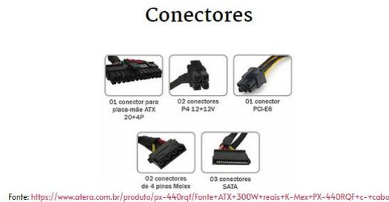
A fonte possui diferentes cabos, pois cada componente possui um conector diferente, por exemplo, o cabo para o HD é diferente do cabo para a Placa de Vídeo, e por essas razões foi criado padrões de conectores, os padrões falados aqui seriam os mais recentes atualmente:
